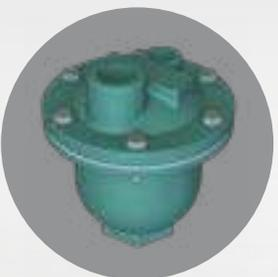
El MetraVent aprobado por FM cumple con los requisitos del código NFPA 2016 para los sistemas de rociadores contra incendios húmedos. NFPA 13 2016 requiere que se instale un respirador de aire para cada sistema de rociadores contra incendios en la red para reducir la actividad de corrosión debido al aire atrapado. El MetraVent cumple con el nuevo requisito NFPA 13 para ventilar aire en un sistema de tubería húmeda.
