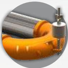
El Seismic Breakaway Hanger está diseñado para separarse a un peso predeterminado cuando este es mayor que el peso de la junta sísmica en un estado estático. Esto permite que la junta sísmica tenga libertad completa de movimiento para proteger su sistema de tubería así como el edificio de daños causados por un evento sísmico.
